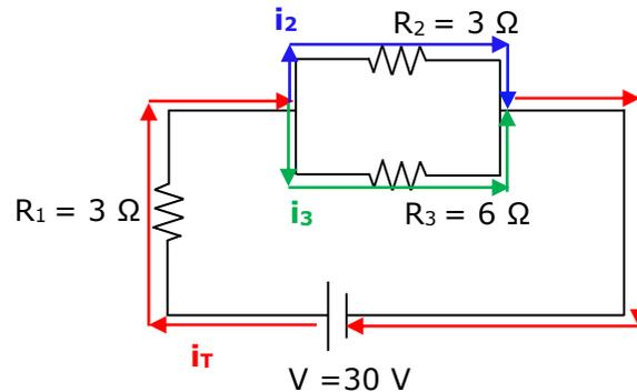
La intensidad total del circuito ( $i_T$ ) circula a través de  $R_1$  y luego se divide pasando  $i_2$  a través de  $R_2$  e  $i_3$  a través de  $R_3$ .
