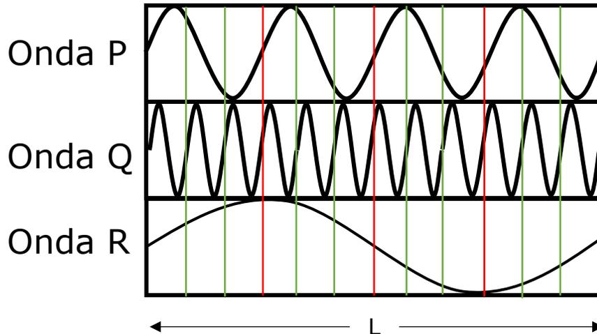
En verde se ve que la onda Q genera en el largo L, 12 oscilaciones, mientras que la onda P, 3 oscilaciones (En rojo) y la onda R solo 1 oscilación. Por lo tanto, sus longitudes de onda son:
