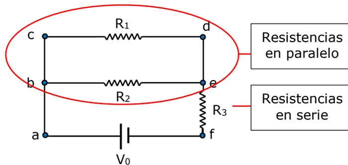
Las resistencias en paralelo reciben el mismo voltaje que se podría medir entre los puntos  $c$  y  $d$  o  $b$  y  $e$ . Con cualquiera de las dos mediciones se obtendría el voltaje de esa zona. Luego este resultado se debería sumar con el voltaje entre los puntos  $e$  y  $f$ , para obtener el voltaje total  $V_0$ .
